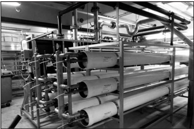
شکل شماره ۷-۱۷- استوانه‌های فشار در تاسیسات نانوفیلتر
