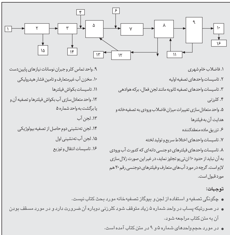
شکل شماره ۴-۳ - دیگرام فرایندهای تصفیه فاضلاب و تصفیه تکمیلی برای استفاده در کشاورزی
